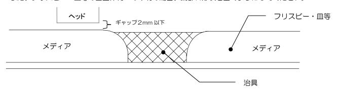
2.立体物の印刷には反射光を防ぐために吸着盤面の余白を覆ってください。 (ヘッドの移動やYバー移動の妨げにならぬようお願いします)
